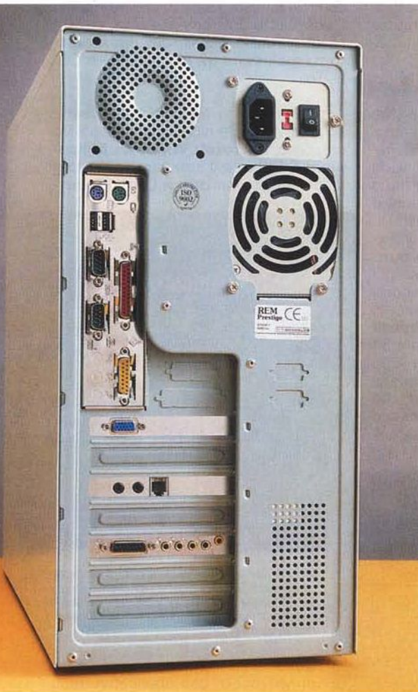
Vista del retro del REM Prestige. Da notare che oltre alle usuali connessioni offerte della SoundBlaster Live!, sulla scheda madre FastFrame è presente un chip on-board per la codifica AC97 che controlla altre linee I/O. Queste vengono comunemente disabilitate al momento dell'inserzione della scheda audio.
